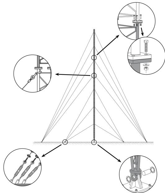
Consiste nel fissare alla base la Sezione inferiore e collocarlo in posizione verticale livellandolo. Nella Sezione posteriore si montano le i pezzi intermedi successivi, che saranno dotati di venti corrispondenti; il montaggio avviene scalando le sezioni già posizionate e quindi il sollevamento della Sezione che deve essere posizionata, aiutandosi con attrezzature di sollevamento.
