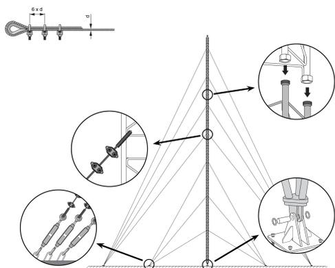
Consiste nel fissare alla base la Sezione inferiore e collocarlo in posizione verticale livellandolo. Nella Sezione posteriore si montano le i pezzi intermedi successivi, che saranno dotati di venti corrispondenti; il montaggio avviene scalando le sezioni già posizionate e quindi il sollevamento della Sezione che deve essere posizionata, aiutandosi con attrezzature di sollevamento.
