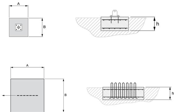
Disegno delle fondamenta della base del traliccio
