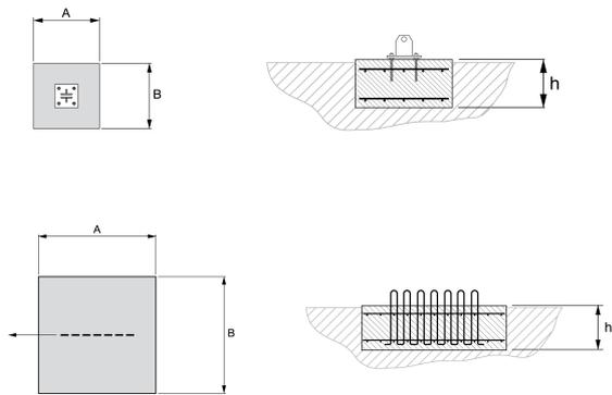
Disegno delle fondamenta della base del traliccio (Nodo centrale) fondamenta dei tiranti (nodo intermedio/esterno).
