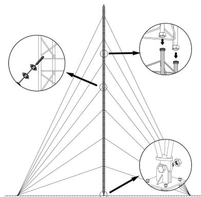
Consiste nel fissare alla base la Sezione inferiore e collocarlo in posizione verticale livellandolo. Nella Sezione posteriore si montano le i pezzi intermedi successivi, che saranno dotati di venti corrispondenti; il montaggio avviene scalando le sezioni già posizionate e quindi il sollevamento della Sezione che deve essere posizionata, aiutandosi con attrezzature di sollevamento.
