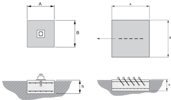
Disegno delle fondamenta della base del traliccio (Nodo centrale) fondamenta dei tiranti (nodo intermedio/esterno).
