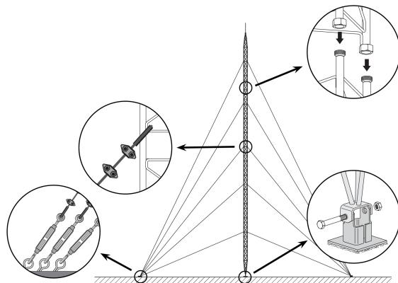
Consiste nel fissare alla base la Sezione inferiore e collocarlo in posizione verticale livellandolo. Nella Sezione posteriore si montano le i pezzi intermedi successivi, che saranno dotati di venti corrispondenti; il montaggio avviene scalando le sezioni già posizionate e quindi il sollevamento della Sezione che deve essere posizionata, aiutandosi con attrezzature di sollevamento.
