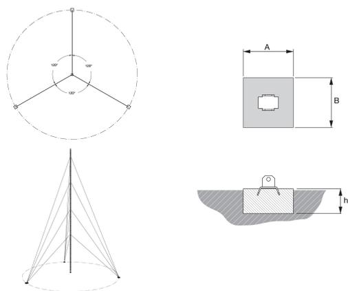
Disegno delle fondamenta della base del traliccio (Nodo centrale) fondamenta dei tiranti (nodo intermedio/esterno).
