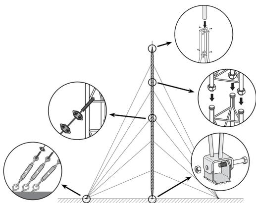
Consiste nel fissare alla base la Sezione inferiore e collocarlo in posizione verticale livellandolo. Nella Sezione posteriore si montano le i pezzi intermedi successivi, che saranno dotati di venti corrispondenti; il montaggio avviene scalando le sezioni già posizionate e quindi il sollevamento della Sezione che deve essere posizionata, aiutandosi con attrezzature di sollevamento.
