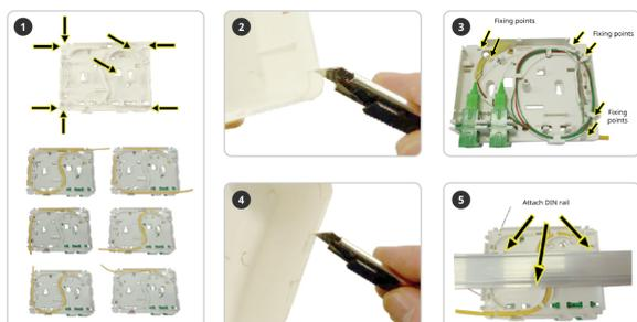
1. Selezionare la voce più adatta per il cavo in fibra ottica, mantenendo il percorso della fibra uniformemente curvo.
