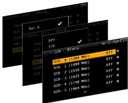
L'H30Crystal è configurato per impostare automaticamente i parametri necessari ed egganciare il suo segnale satellitare. Inoltre con l'H30Crystal potremo alimentare amplificatori da palo, configurare parametri DiSEqC e SCR/dCSS.
