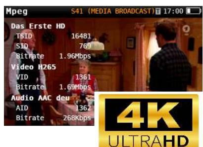
Questa funzione supporta il formato di compressione HEVC H.265 e consente di visualizzare segnali video con una risoluzione massima 4K - UHD (3840 x 2160). Le informazioni possono essere visualizzate sia sullo schermo del misuratore che sul dispositivo mobile (modalità multischermo) purché l'hardware sia compatibile H.265 (solitamente uno smartphone, un tablet o un PC).
