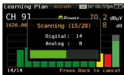
Scopri quali canali sono presenti nella sua distribuzione con la funzione ultra-veloce di Cattura Piano e crei un piano di canali ad hoc formato da quelli di suo interesse. Inoltre il livello di qualità del canale selezionato, verrà visualizzato con barre grafiche colorate in funzione delle soglie di qualità selezionate.
