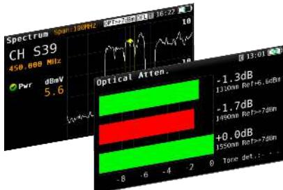
Questa apparecchiatura è dotata di un ricevitore ottico (opzione selettiva e non selettiva) che consente di misurare la potenza e l'attenuazione a lunghezze d'onda di 1310 nm, 1490 nm e 1550 nm. Combinare l'opzione selettiva con il generatore di tripla luce (OPS3L) è la scelta giusta per installare, monitorare e ricercare guasti nelle distribuzioni FTTH.
