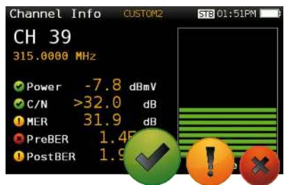
Si riducono gli errori nell'installazione con gli indicatori SUPERATO/FALLITO, con una rappresentazione grafica che facilita e rende intuitiva l'interpretazione delle misure. Si dispone di differenti soglie in funzione della posizione di misura lungo la distribuzione: centrale di testa, amplificatori, distribuzione, prese, etc. Oltre ai valori di default, potrà personalizzare le sue soglie.
