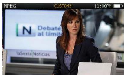
Vuole sapere quali contenuti vengono offerti in un canale DIGITALE? La funzione MPEG dell'H30Crystal ve lo dirà. Oltre a mostare le immagini dei servizi del canale, mostrerà anche parametri importanti riferiti agli stessi: Nome del servizio, PID, risoluzione, tipo e numero di audio e NIT. Un grande aiuto per risolvere problemi relativi alla configurazione della codifica.
