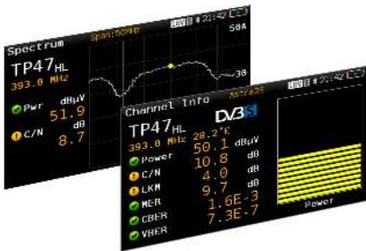
Questa funzione per il DVB-S/S2, consente di analizzare al completo un canale satellitare su qualunque frequenza di un'ampia banda, compresa tra 250 - 2300MHz. Così, è possibile collegare il misuratore direttamente a qualunque uscita del LNB Wideband (2 uscite: Verticale e Orizzontale)
