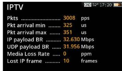
Permette di demodulare e analizzare flussi Unicast e Multicast IPTV, fa vedere il video e i Bitrates totali e di ogni servizio. Presenta anche tutta l'informazione di ognuno dei servizi, come SID, VPID, AID, profilo di video, o bit rate per audio e video.
