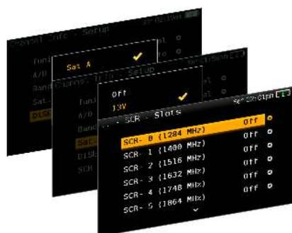
L'H30Evolution è configurato per impostare automaticamente i parametri necessari ed eagganciare il suo segnale satellitare. Inoltre con l'H30Evolution potremo alimentare amplificatori da palo, configurare parametri DiSEqC e SCR/dCSS.
