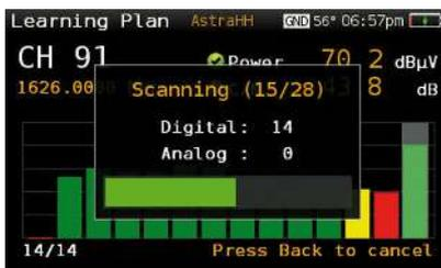
Scopra quali canali sono presenti nella sua distribuzione con la funzione ultra-veloce di Cattura Piano e crei un piano di canali ad hoc formato da quelli di suo interesse. Inoltre il livello di qualità del canale selezionato, verrà visualizzato con barre grafiche colorate in funzione delle soglie di qualità selezionate.
