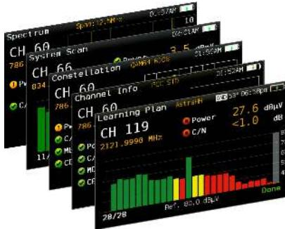
Una completa scelta di funzioni di default come Misure di un solo Canale, Diagramma di Costellazione, Analizzatore di Spettro, Identificazione del Servizio, Datalogs, Autoapprendimento del Piano Canali e tanto altro.
