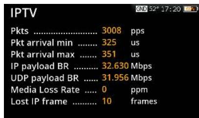
Permette di demodulare e analizzare flussi Unicast e Multicast IPTV, fa vedere il video e i Bitrates totali e di ogni servizio. Presenta anche tutta l'informazione di ognuno dei servizi, come SID, VPID, AID, profilo di video, o bit rate per audio e video.
