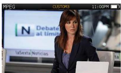
Vuole sapere quali contenuti vengono offerti in un canale DIGITALE? La funzione MPEG dell'H30Evolution ve lo dirà. Oltre a mostare le immagini dei servizi del canale, mostrerà anche parametri importanti riferiti agli stessi: Nome del servizio, PID, risoluzione, tipo e numero di audio e NIT. Un grande aiuto per risolvere problemi relativi alla configurazione della codifica.
