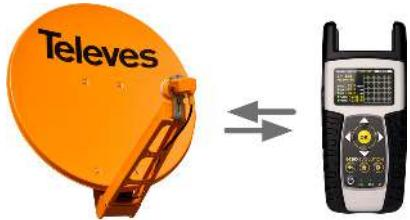
Questa funzione consente di facilitare il lavoro di orientamento della parabola. Il misuratore ottiene un satellite tipico e un transponder stabile in funzione dell'area geografica impostata, e si auto configura per la connessione con LNB. Inoltre, è possibile attivare un indicatore sonoro che guida acusticamente l'utente nel puntamento della parabola.
