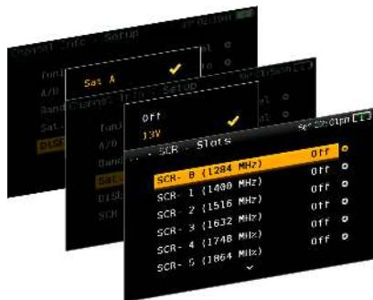
L'H30Evolution è configurato per impostare automaticamente i parametri necessari ed egganciare il suo segnale satellitare. Inoltre con l'H30Evolution potremo alimentare amplificatori da palo, configurare parametri DiSEqC e SCR/dCSS.
