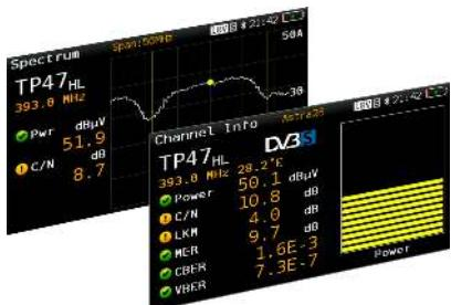
Questa funzione per il DVB-S/S2, consente di analizzare al completo un canale satellitare su qualunque frequenza di un'ampia banda, compresa tra 250 – 2300MHz. Così, è possibile collegare il misuratore direttamente a qualunque uscita del LNB Wideband (2 uscite: Verticale e Orizzontale)
