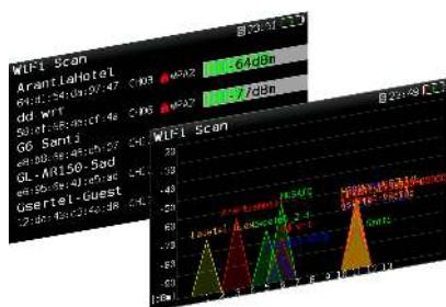
Con questa funzione è possibile realizzare l'analisi completa della banda WiFi per determinare automaticamente tutte le reti. Ognuna di esse è identificata con il proprio nome ed inoltre viene mostrato anche la potenza del segnale del punto di accesso. Sono possibili due modi di visualizzazione, a scelta dell'utente. Il modo "elenco" offre la lista delle reti determinate con i loro dati e la potenza, mentre il modo "mappa" realizza un grafico ad assi: potenza vs frequenza.
