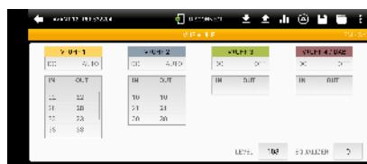
Il livello del segnale di ogni canale viene elaborato automaticamente dal dispositivo, ottenendo il massimo livello possibile e bilanciando tutti i canali filtrati, in modo che non vi siano fluttuazioni del segnale tra di essi.
