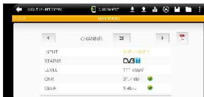
ASuite può monitorare parametri specifici degli standard DVB-T e DVB-T2 come CNR, CBER o PER e visualizzarli sull'applicazione in tempo reale, per ogni canale filtrato.
