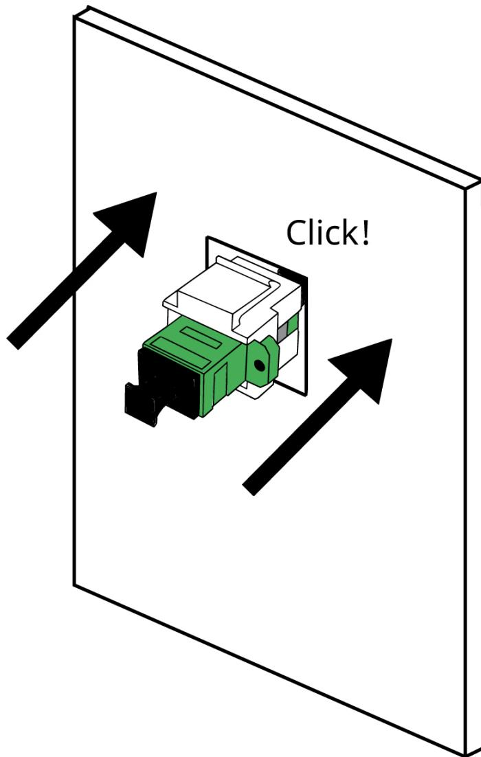
Infine, una volta che l'installazione è stata completata, rimuovere i cappucci protettivi e collegare il cavo di connessione alla presa.
