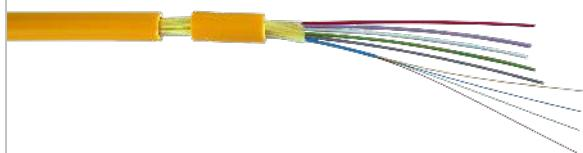
Cavo multifibra FK24 monomodale 24 fibre, Euroclasse Dca e LSFH resistente ai raggi UV, da interno/esterno
