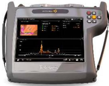
Funzione che consente di visualizzare e misurare canali TV analogici ancora utilizzati nei sistemi TV basati su trasmodulatori. Permette di misurare segnali con livelli tra 20 e 128 dBu, C / N fino a 52 dB e V / A fino a 30 dB.
