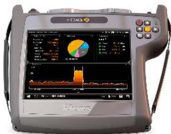
Funzione che consente di demodulare un canale DAB, offrendo misure di qualità del segnale come MER e CBER, nonché informazioni complete sui servizi trasmessi: Informazioni radio: (Ensemble, PTY, Servizio, Modalità, Audio-, bit rate audio). Permette di misurare la potenza tra 20 e 128 dBμV, C / N e MER di questo tipo di segnali.
