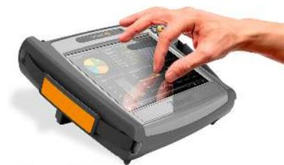
Questa nuova interfaccia è stata progettata e programmata per sfruttare al massimo i gesti tattili (premere una o due volte, premere a lungo, far scorrere, trascinare, ingrandire o ridurre). Solo in questomodo è possibile lavorare così facilmente con un misuratore di campo ad altissime prestazioni.
