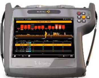
Riduci gli errori di installazione con gli indicatori di schermo Pass / Fail, una forma grafica che facilita e accelera l'interpretazione dei risultati di misurazione. Sono disponibili diverse soglie in base alla parte della rete da analizzare: intestazione, amplificatore centrale, derivazione, registri di connessione, alloggiamento utente, ecc. Oltre ai valori preimpostati, è anche possibile personalizzare i propri valori di soglia.
