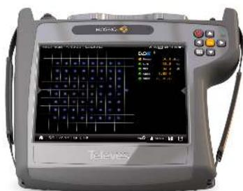
Il diagramma delle costellazioni è essenziale per aiutare a rilevare la presenza di rumore, jitter di fase, interferenze e altri problemi che possono interessare la qualità del segnale riducendo il MER. La rappresentazione grafica degli echi permette di identificare la loro presenza nella ricezione del segnale digitale terrestre DVB-T / T2, cosa che può rendere degradabile in modo considerevole la misura di BER.
