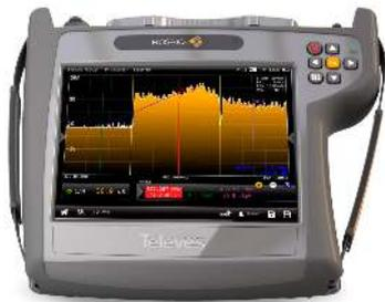
Analizzatore di spettro professionale con elaborazione digitale ultrarapida (tempo di scansione <math>< 10 \text{ ms}</math>) e con elevato margine dinamico (> 50 dB). È dotato di funzioni avanzate per il rilevamento e l'analisi di segnali tra 5 MHz e 3300 MHz (spettrografia, trigger di eventi, marker, RBW e VBW configurabili dall'utente, ecc.).
