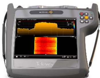
I livelli del segnale vengono convertiti in colori e sono rappresentati sull'asse del tempo (vedi figura). Uno strumento ottimale per analizzare interferenze o dissolvenze di segnale di breve durata che con il solo spettro sarebbero difficili da rilevare.
