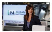
Vuole sapere quali contenuti vengono offerti in un canale DIGITALE? La funzione MPEG dell'H30FLEX ve lo dirà. Oltre a mostare le immagini dei servizi del canale, mostrerà anche parametri importanti riferiti agli stessi: Nome del servizio, PID, risoluzione, tipo e numero di audio e NIT. Un grande aiuto per risolvere problemi relativi alla configurazione della codifica.
