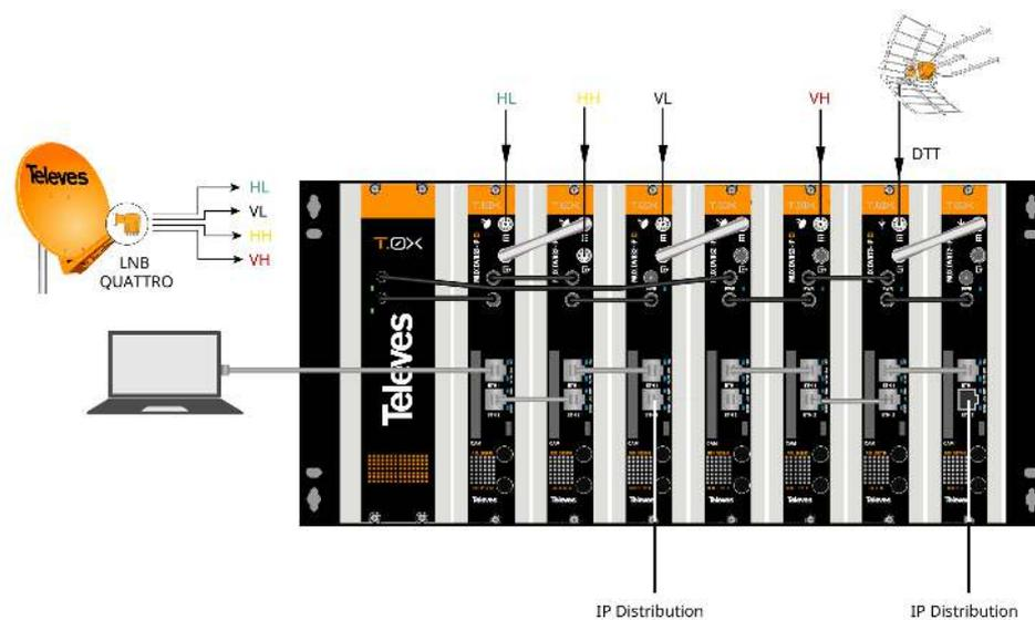
Collega le uscite ETH2 delle unità allo switch di distribuzione video esterno con cavi Ethernet CAT6.
