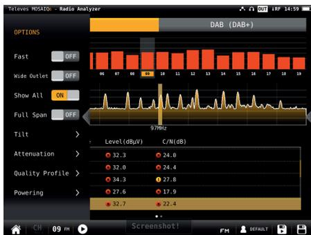
•**Veloce:** ON/OFF. Quando la scansione veloce è attiva (ON), non verranno effettuate misure di MER e CBER per i canali digitali. Sarà misurato solo il livello o potenza e il C/N.
