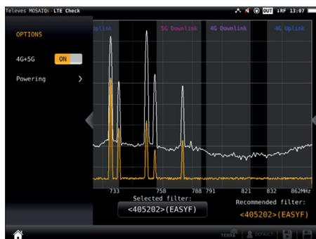
•4G + 5G: ON/OFF. Quando è selezionato ON, la funzione analizza i collegamenti up e down 4G, nonché i collegamenti up e down 5G, rilevando eventuali segnali di disturbo e, se necessario, consiglia un filtro.
