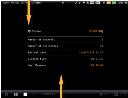
Numero di canali: è il numero di canali selezionati dall'utente da misurare in ogni iterazione. Iterazioni: numero di iterazioni del test effettuate dall'inizio ad oggi. Data iniziale: data in cui è iniziato il test. Tempo trascorso: tempo trascorso dalla data di inizio ad oggi
