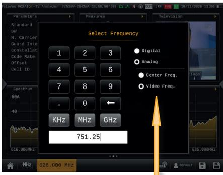
Quando è selezionata la banda terrestre e il misuratore è impostato sulla funzione TV Analyser, è possibile scegliere tra frequenza portante video o frequenza centrale.
