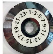
Finché la taglierina funziona correttamente, non modificare la posizione della lama, anche se sono stati eseguiti più di 1.000 tagli. Dovresti modificare la posizione della lama solo se noti che nonostante la sua posizione sia corretta, la lama non è in grado di tagliare.
