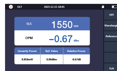
7. Optical Loss Test / Test des optischen Verlusts
