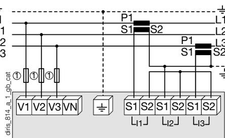
L'utilizzo di 2 TA riduce dello 0,5% la precisione delle fasi da cui la corrente viene dedotta con il calcolo vettoriale.
