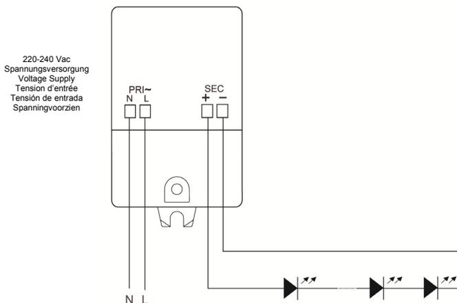
Die maximale Länge der Ausgangsleitung von 2 m darf nicht überschritten werden
