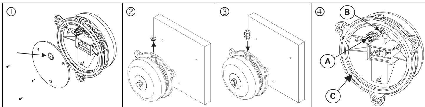
A garanzia della tenuta IP, prima dell'installazione, verificare l'integrità della guarnizione [C].
