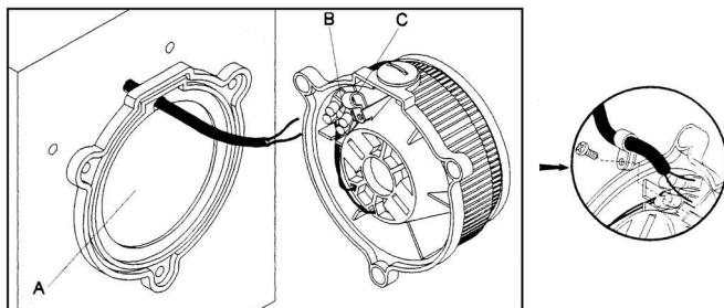
Per garantire la tenuta IP montare sempre la guarnizione fornita a corredo ed installare a parete con il pressacavo verticale rivolto, o verso l'alto [3] o verso il basso [4].
