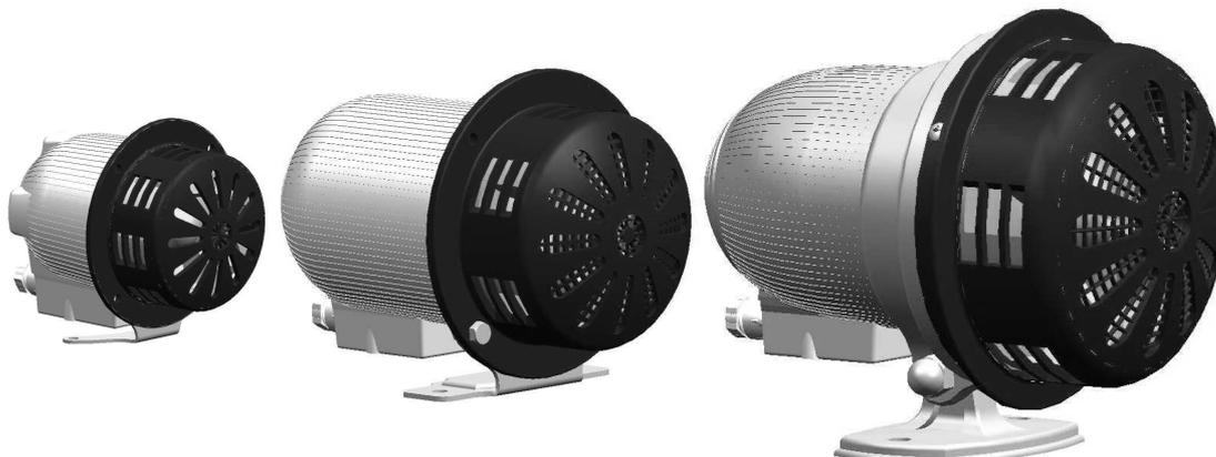
Sirene elettromeccaniche industriali per servizio continuo (**BA = On ∞**) a basso assorbimento DC (12V - 24V); e per servizio non continuo (Vac/dc). Nelle CELERE e SUPERCELERE versioni 110Vac - 240Vac vi è installato un termointerruttore di protezione motore. Tipo di alimentazione per utilizzo continuo: **On: 1 min. Off: 10 min.**
