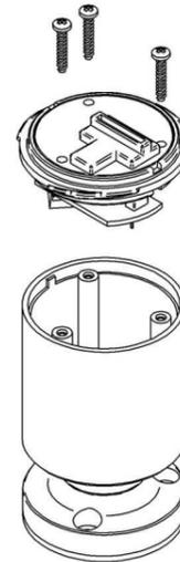
Per accedere alla morsetteria dei collegamenti, svitare le viti e sfilare il coperchio di protezione. **Sulla linea di alimentazione usare fusibili ritardati dimensionati a seconda della tensione.**
