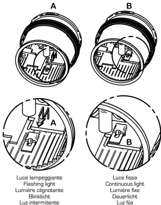
E' possibile impostare la funzione **Luce Fissa** o **Luce Lampeggiante** su ogni modulo, mantenendo o rimuovendo il ponticello presente sul circuito.
