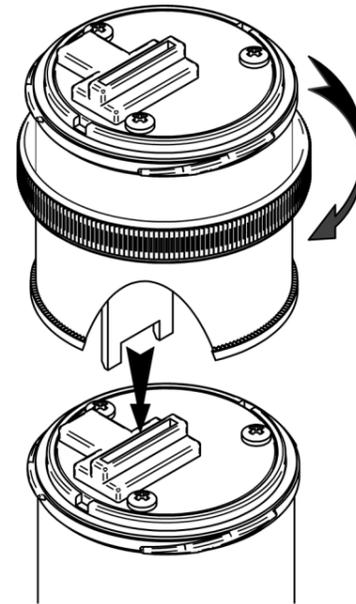
Posizionare il circuito stampato del modulo nell'apposita feritoia e spingere verso il basso. Ruotare la ghiera nella direzione indicata (senso orario) fino al bloccaggio totale (5Nm). Su ogni modulo BASE si possono montare fino a 5 elementi di segnalazione: **[5 moduli luminosi] o [4 moduli luminosi + modulo acustica]**. **IMPORTANTE** - Il modulo acustico va sempre montato al vertice della torretta luminosa ed è già provvisto di cappello di chiusura.
