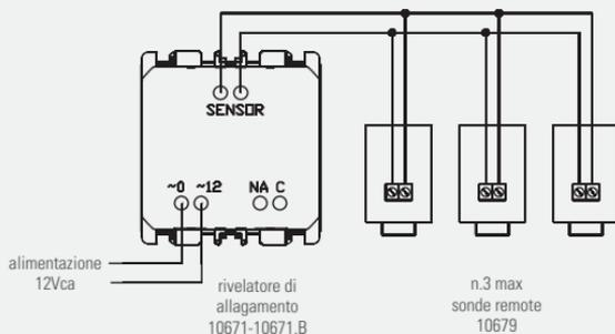
NOTA: Le sonde remote devono essere collegate in parallelo tra loro. Deve essere impiegato cavo 2x0,75 mm<sup>2</sup> da posare in canalizzazioni separate da quelle per i cavi delle linee di potenza. La somma delle tratte di collegamento delle sonde non deve superare i 50m.
