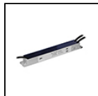
S.2416 ALIMENTATORE DIMMERABILE DALI 2 230Vac/24Vdc 75W 244Hz IP67 Dimmerabile DALI 2 per led monocolor 75W 230Vac/24Vdc Il numero massimo degli apparecchi collegabili dipende dalla somma delle singole potenze. IP67 CLASSE II SELV Frequenza PWM : 244Hz Dimensioni 280 x 40x 28mm SI CONSIGLIA L'UTILIZZO DELLO SCARICATORE DI SOVRATENSIONE S.2499 PER OGNI ALIMENTATORE ELETTRONICO CHE DEVE ESSERE INSTALLATO A MAX 10m DI DISTANZA DA QUEST'ULTIMO.
