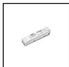
S.2419 ALIMENTATORE DIMMERABILE DALI2, PUSH DIM 36W 230Vac/24Vdc 3,6KHz IP20 Dimmerabile DALI2, PUSH DIM per led monocolori 36W 230Vac/24Vdc Il numero massimo degli apparecchi collegabili dipende dalla somma delle singole potenze. IP20 CLASSE II SELV Frequenza PWM :
