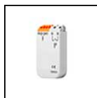
S.2495 INTERFACCIA DALI2 per APPARECCHI 230V ON-OFF (NON DIMMERABILI) Consente il controllo da remoto degli apparecchi non dimmerabili 230V ON-OFF tramite il protocollo DALI2. IP20 Max nominal load 1000VA Max switching current 8A Max inrush current 80A NB: l'apparecchio sarà controllabile da remoto nella sola modalità ON-OFF e non in modalità dimmerata. Dimensioni 32,5mm x 15mm x 58,5mm La somma delle Inrush current degli apparecchi che si vogliono collegare a questa interfaccia, non deve superare il valore massimo sopportabile pari a 80A.
