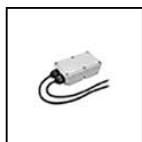
S.2496 INTERFACCIA DALI2 per APPARECCHI 230V ON-OFF (NON DIMMERABILI) Consente il controllo da remoto degli apparecchi non dimmerabili 230V ON-OFF tramite il protocollo DALI2. IP67 Max nominal load 1000VA Max switching current 8A Max inrush current 80A Dimensioni 175,5mm x 86,5mm x 43mm NB: l'apparecchio sarà controllabile da remoto nella sola modalità ON-OFF e non in modalità dimmerata. La somma delle Inrush current degli apparecchi che si vogliono collegare a questa interfaccia, non deve superare il valore massimo sopportabile pari a 80A.
