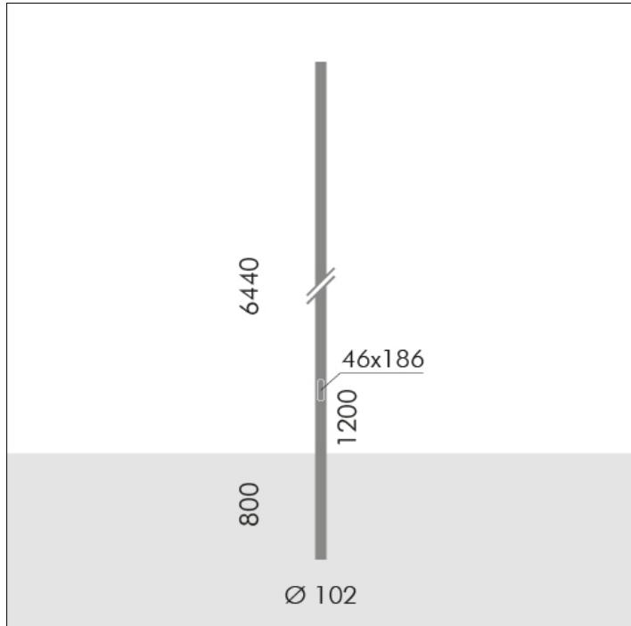
**S.2815****PALO CILINDRICO H 6,44m f.t., Ø102mm DA
