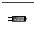
S.2448 ALIMENTATORE ON-OFF 31W 230Vac/48Vdc IP67 Alimentatore per led monocolore 31W 230Vac/48Vdc Il numero massimo degli apparecchi collegabili dipende dalla somma delle singole potenze. IP67 CLASSE II SELV Dimensioni 120x38x25mm SI CONSIGLIA L'UTILIZZO DELLO SCARICATORE DI SOVRATENSIONE S.2499 PER OGNI ALIMENTATORE ELETTRONICO CHE DEVE ESSERE INSTALLATO A MAX 10m DI DISTANZA DA QUEST'ULTIMO.
