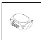
S.3452 DIMMER BOX DMX IP66 (5 Uscite) Il seguente dimmer serve per controllare il colore e regolazione dell'intensità luminosa del LED RGB-WW tramite segnale DMX. Questo dispositivo necessita di un alimentatore 24Vdc non dimmerabile (tipo S.2405, S.2406, S.2445 e S.2446) e deve essere collocato tra l'alimentatore 24Vdc e l'apparecchio. Scegliere quindi un alimentatore 24V in base alla massima potenza impegnata degli apparecchi fino ad un massimo di 240W. IP66 Dimensioni 210mmx200mmx92mm
