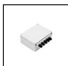
S.2423 BOX CON ALIMENTATORE DIMMERABILE DALI2, 1-10v e PUSH-DIM 60W 230Vac/24Vdc 2kHz IP55 MAX 5 USCITE 60W 230Vac/24Vdc Dimensioni 260mmx240mmx100mm Frequenza PWM : 2kHz IP55 SELV CLASSE II NB: non compatibile per famiglie prodotto NANOLED INOX SI CONSIGLIA L'UTILIZZO DELLO SCARICATORE DI SOVRATENSIONE S.2499 PER OGNI ALIMENTATORE ELETTRONICO CHE DEVE ESSERE INSTALLATO A MAX 10m DI DISTANZA DA QUEST'ULTIMO.
