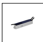
S.2415 ALIMENTATORE DIMMERABILE DALI 230Vac/24Vdc 24W 244Hz IP67 Dimmerabile DALI per led monocolori 24W 230Vac/24Vdc Il numero massimo degli apparecchi collegabili dipende dalla somma delle singole potenze. IP67 CLASSE II SELV Frequenza PWM : 244Hz Dimensioni 185 x 35x 33mm SI CONSIGLIA L'UTILIZZO DELLO SCARICATORE DI SOVRATENSIONE S.2499 PER OGNI ALIMENTATORE ELETTRONICO CHE DEVE ESSERE INSTALLATO A MAX 10m DI DISTANZA DA QUEST'ULTIMO.
