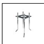
S.2849 TIRAFONDI per pali S.2801, S.2813, S.2843, S.2845 in acciaio zincato con bulloni M16, C= 200mm, D=200mm E=Ø80mm, h=460mm, h1=90mm. Si consiglia l'uso in plinto di cemento armato di dimensioni **: A = 0.7 m B = 0.7 m ** Le dimensioni del plinto possono essere ottimizzate a seconda della consistenza del terreno, seguendo le indicazioni delle normative UNI EN 40.
