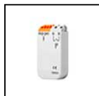
S.2495 INTERFACCIA DALI2 per APPARECCHI 230V ON-OFF (NON DIMMERABILI) Consente il controllo da remoto degli apparecchi non dimmerabili 230V ON-OFF tramite il protocollo DALI2. IP20 Max nominal load 1000VA Max switching current 8A Max inrush current 80A NB: l'apparecchio sarà controllabile da remoto nella sola modalità ON-OFF e non in modalità dimmerata. Dimensioni 32,5mm x 15mm x 58,5mm La somma delle Inrush current degli apparecchi che si vogliono collegare a questa interfaccia, non deve superare il valore massimo sopportabile pari a 80A.
