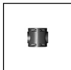
S.1018 STAFFA PER AGGANCIO A PALO Ø102mm Staffa in alluminio pressofuso per aggancio a palo. Utilizzabile solamente per pali Ø 102. La staffa è predisposta per agganciare fino a due proiettori, uno per lato.
