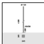
S.2846 PALO CILINDRICO H 4,2m f.t., Ø120mm FLANGIATO
