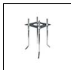
S.2840 TIRAFONDI PER PALI S.2846, S.2848 In acciaio zincato con bulloni M16, h = 550 mm. Si consiglia l'uso in plinto di cemento armato di dimensioni: A = 0.7 m B = 1 m Le dimensioni del plinto possono essere ottimizzate a seconda della consistenza del terreno, seguendo le indicazioni delle normative UNI EN 40. SI CONSIGLIA L'UTILIZZO DEI SEGUENTI ACCESSORI: S.2846, S.2848 PALI
