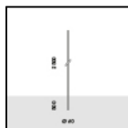
S.2800 PALO CILINDRICO H 2,5m f.t., Ø60mm DA INTERRARE Palo cilindrico costituito da: fusto dritto a sezione circolare, Ø 60mm, spessore 3mm, lunghezza totale 3,00m, in unico tronco costruito utilizzando tubi saldati longitudinalmente ad induzione (ERW) UNI EN 10219-2 - ISO 4200.
