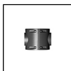
S.1239 STAFFA PER AGGANCIO A PALO Ø120mm Staffa in alluminio pressofuso per aggancio a palo. Utilizzabile solamente per pali Ø 120mm. La staffa è predisposta per agganciare fino a due proiettori, uno per lato.
