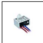
S.2499 SCARICATORE SOVRATENSIONE 10kV CLASSE II Compatibile con tutti gli apparecchi di illuminazione ed alimentatori elettronici in Classe di Isolamento CLASSE II Tensione di funzionamento 230-277V SPD type 2+3 Tensione massima di scarica 10kV grado di protezione IP67 DEVE ESSERE PREVISTO N°1 SCARICATORE DI SOVRATENSIONE PER OGNI APPARECCHIO DI ILLUMINAZIONE E DEVE ESSERE INSTALLATO A MAX 10m DI DISTANZA DA QUEST'ULTIMO.
