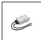
S.2496 INTERFACCIA DALI2 per APPARECCHI 230V ON-OFF (NON DIMMERABILI) Consente il controllo da remoto degli apparecchi non dimmerabili 230V ON-OFF tramite il protocollo DALI2. IP67 Max nominal load 1000VA Max switching current 8A Max inrush current 80A Dimensioni 175,5mm x 86,5mm x 43mm NB: l'apparecchio sarà controllabile da remoto nella sola modalità ON-OFF e non in modalità dimmerata. La somma delle Inrush current degli apparecchi che si vogliono collegare a questa interfaccia, non deve superare il valore massimo sopportabile pari a 80A.
