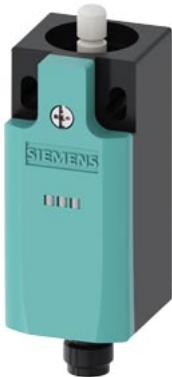
interruttore di posizione custodia in plastica, 31 mm secondo DIN EN 50047 contatti ad azione lenta 1NO/1NC con connettore M12, a 5 poli, fisso 2x LED giallo/verde DC 24 V pulsante in teflon Assegnazione dei pin: Pin1=21, Pin2=22 Pin3=14 LED verde, Pin4=13 e LED giallo Pin5=LED di massa e LED giallo Pin 5=massa LED
