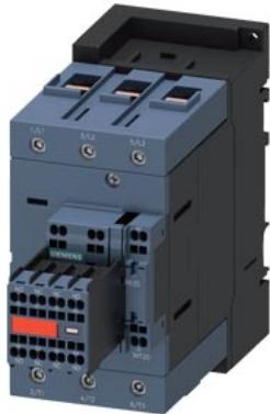
contattore di potenza, AC-3e/AC-3, 95 A, 45 kW / 400 V, a 3 poli, AC/DC 20...33 V, 50/60 Hz, con varistore integrato, contatti ausiliari: 2 NO + 2 NC, circuito principale: morsetti a vite, circuito di comando e circuito ausiliario: morsetti a molla, grandezza costruttiva: S3, blocchetto di contatti ausiliari non rimovibile
