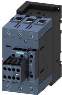
contattore di potenza, AC-3e/AC-3, 95 A, 45 kW / 400 V, a 3 poli, AC/DC 83...155 V, 50/60 Hz, con varistore integrato, contatti ausiliari: 2 NO + 2 NC, morsetti a vite, grandezza costruttiva: S3, blocchetto di contatti ausiliari rimovibile
