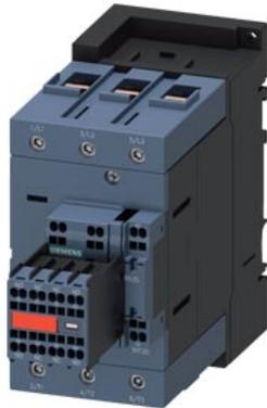
contattore di potenza, AC-3e/AC-3, 80 A, 37 kW / 400 V, a 3 poli, AC 230 V, 50 Hz, con varistore innestato, contatti ausiliari: 2 NO + 2 NC, circuito principale: morsetti a vite, circuito di comando e circuito ausiliario: morsetti a molla, grandezza costruttiva: S3, blocchetto di contatti ausiliari non rimovibile
